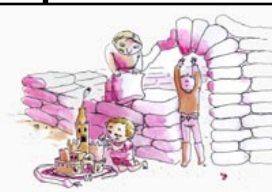
Construction en sacs de sable ou de terre enduits (méthode principalement utilisée en humanitaire d'urgence mais aussi pour l'habitat).
