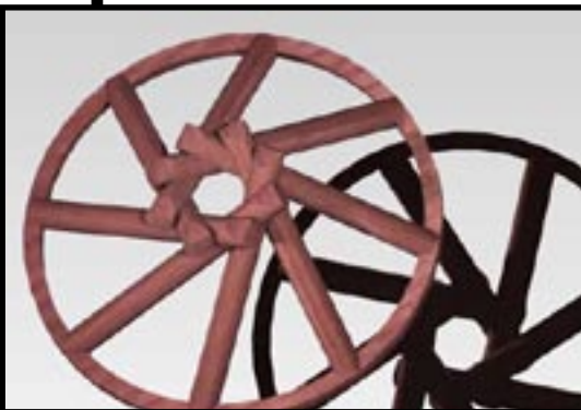
Charpente circulaire autoportée en rondins de bois
